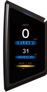
Informează care sunt nivelurile de PM 10 detectate în intrare și în ieșire (în exemplul de mai sus 31 în intrare și 0 în ieșire) și cu privire la mirosuri și particulele volatile
