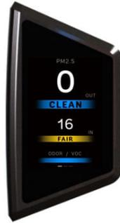
Informează care sunt nivelurile de PM 2.5 detectate în intrare și în ieșire (în exemplul de mai sus 16 în intrare și 0 în ieșire) și cu privire la mirosuri și particulele volatile
