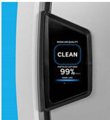
Datorita celor doi senzori laser PM2.5 de inalta calitate, veti putea vedea, de asemenea, calitatea aerului pe masura ce intra si iese din unitate, precum si o vizuala in timp real la nivel de VOC.
